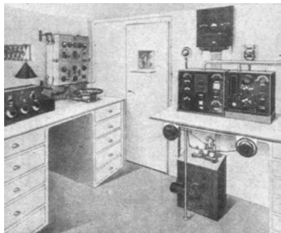
Telefunkenluft- schiffstation in der Kabine des Zep- pelin LZ127 „Graf Zeppelin“ im Jahre 1928
